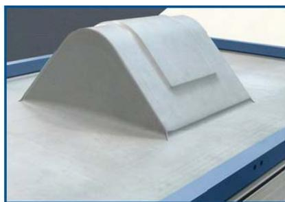
Закройте раму и запустите вакуумный насос. В течение нескольких секунд заготовка будет прижата к матрице с регулируемым усилием до 9 т/м<sup>2</sup>.
