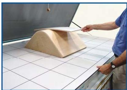
Нанесите клей на листы заготовки из гибкого материала. Установите матрицу посередине стола и уложите на нее заготовку.
